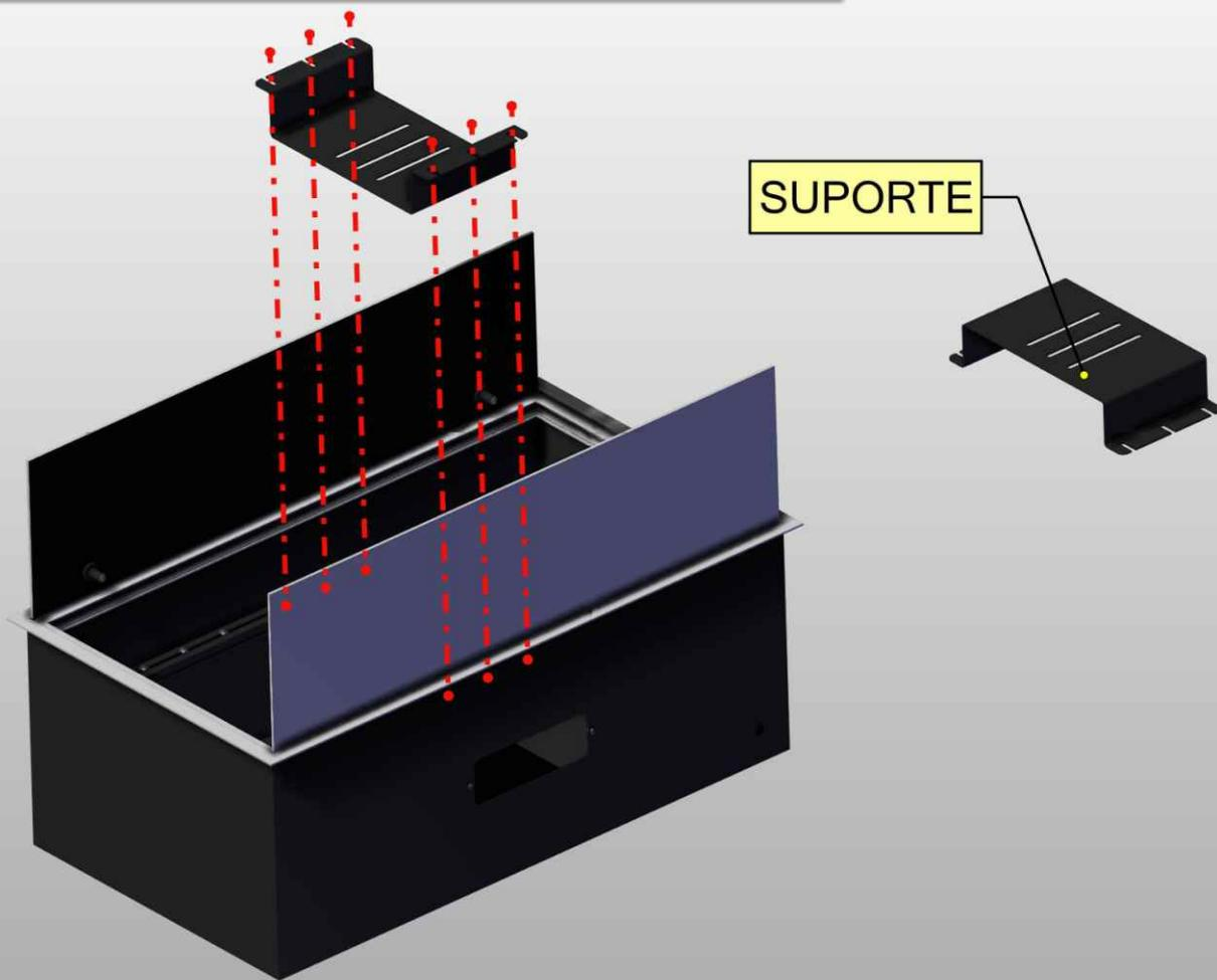
O MECANISMO DO LIFT PODE SER RETIRADO PARA FACILITAR NA INSTALAÇÃO, FICANDO OPCIONAL A RETIRADA DO MESMO.
