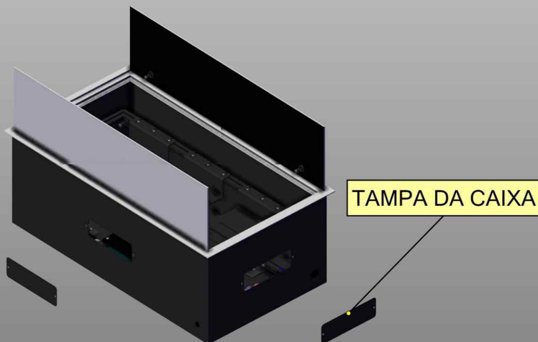
RETIRA A TAMPA DA CAIXA PARA PASSAGEM DE CABOS
