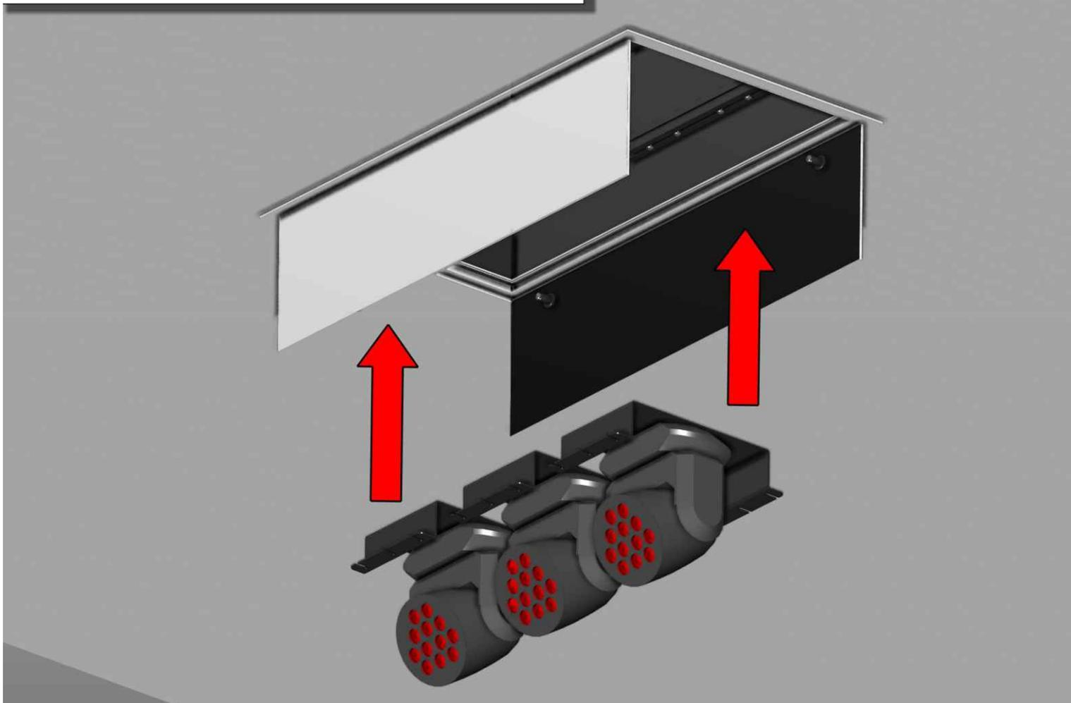
PARA O LIFT DE CANHÃO FECHAR A TAMPA DE ACABAMENTO, PASSE O CABO POR DENTRO DO REGULADOR DE ALTURA.
