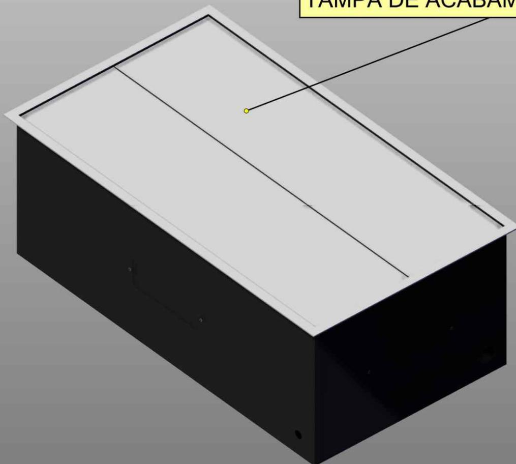
ABRA A TAMPA DE ACABAMENTO DO LIFT PARA ACESSAR O MECANISMO DO LIFT
